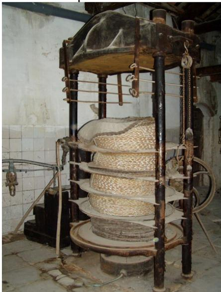
por la que sale el aceite, y una estructura superior, a veces coronada por una torre, en la que se dispone el tornillo que ejercerá la presión. Dicho tornillo se puede girar por hombres, animales de tiro u otros medios.
