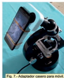
Fig. 7.- Adaptador casero para móvil.
